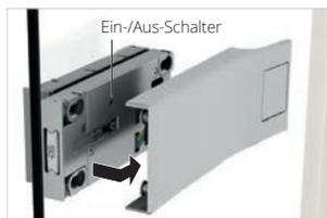
Designblende von beiden Seiten (werkzeuglos) Richtung Türblatt-Mitte abziehen.
